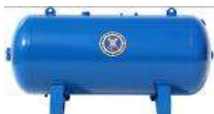
Каждый ресивер в процессе изготовления проходит полный комплекс обязательных испытаний и контроль качества, что гарантирует полную безопасность при эксплуатации. Продольный шов и кольцевые сварные соединения ресивера подвергаются контролю методом ультразвуковой дефектоскопии. Каждый ресивер подвергается гидравлическому испытанию на прочность и плотность; пневматическому испытанию на герметичность.
