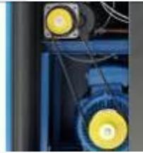
**Ременный привод** "сглаживает" пуск компрессора за счет растяжения ремней, надежен при низких и средних мощностях двигателя. Он прост в эксплуатации, благодаря чему, обслуживание может осуществляться самостоятельно, без необходимости привлечения специалистов. Ременной привод получил на винтовых компрессорах наибольшее применение. А стоимость компрессоров с ременным приводом ниже аналогичных моделей с другим типом привода.
