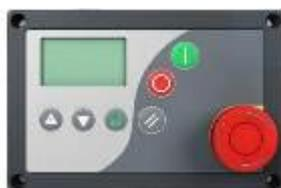
Программируемый многофункциональный контроллер **CMC Airmaster P1 и S1** производится в Бельгии. Контроллер Airmaster отображает текущую информацию о состоянии компрессора, о его нагрузке/холостом ходу, времени отключения, аварийных режимах, времени наработки, обеспечивает доступ к настройкам компрессора, а также о предстоящих ТО. Контроллер Airmaster защищает компрессор и производит его остановку при аварийных ситуациях. Есть возможность дистанционно управлять компрессором.
